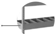
Entrepaño para ser ubicado con paales por medio de tornillo y tuerca, estructura en lámina Cold Rolled Calibre 24 doblado en frío, protegido por pintura en polvo electrostática horneable de alta resistencia.
